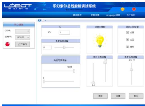
圖19 舵機專用調適系統
