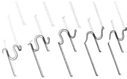
圖24 生物蛇側行原理分解動作圖
